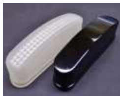
光造形品を真空注型マスターとして仕上げ
